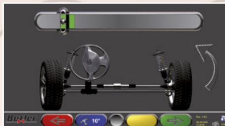
Procedura di sterzata realizzata elettronicamente tramite i sensori CCD per ottenere il valore di incidenza ed inclinazione del montante con elevata precisione.
