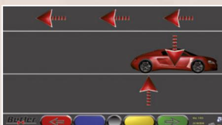
È possibile la misurazione del fuori centro spingendo il veicolo di 30° (compensazione rapida e in poco spazio)\* senza necessità di sollevare il veicolo.
