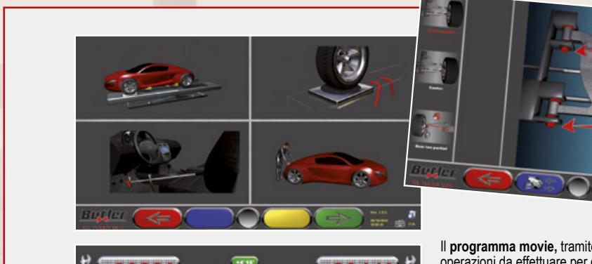
Il programma movie, tramite grafica animata 3D, visualizza la sequenza delle operazioni da effettuare per eseguire una corretta registrazione del veicolo.
