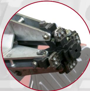
La griffa a gradini permette il bloccaggio interno a partire da 90 mm senza l'uso di accessori.
